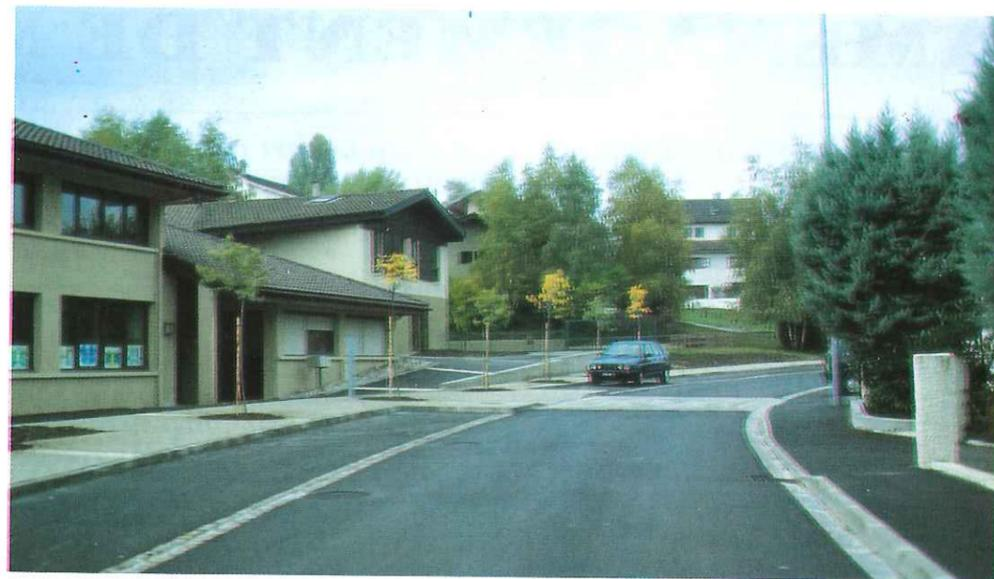
Le ruisseau à ciel ouvert a été canalisé et les eaux de ruissellement collectées au maximum par des grilles. Le profil de la route a été modifié donnant ainsi une pente plus régulière. La chaussée, rétrécie à 3,50 m sur la partie haute, matérialise le sens unique sur ce secteur.
